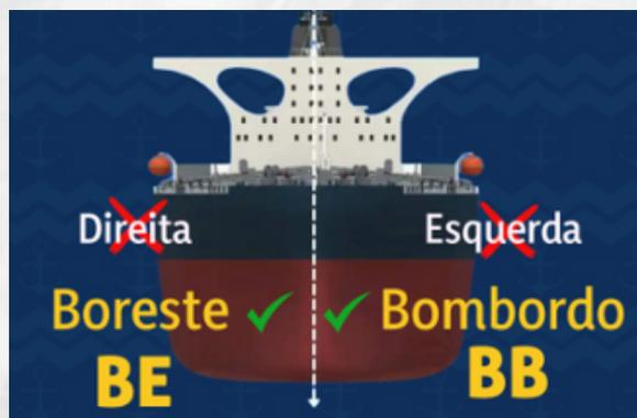
Lado à esquerda da embarcação quando o observador olha, de dentro desta, para a sua proa.
